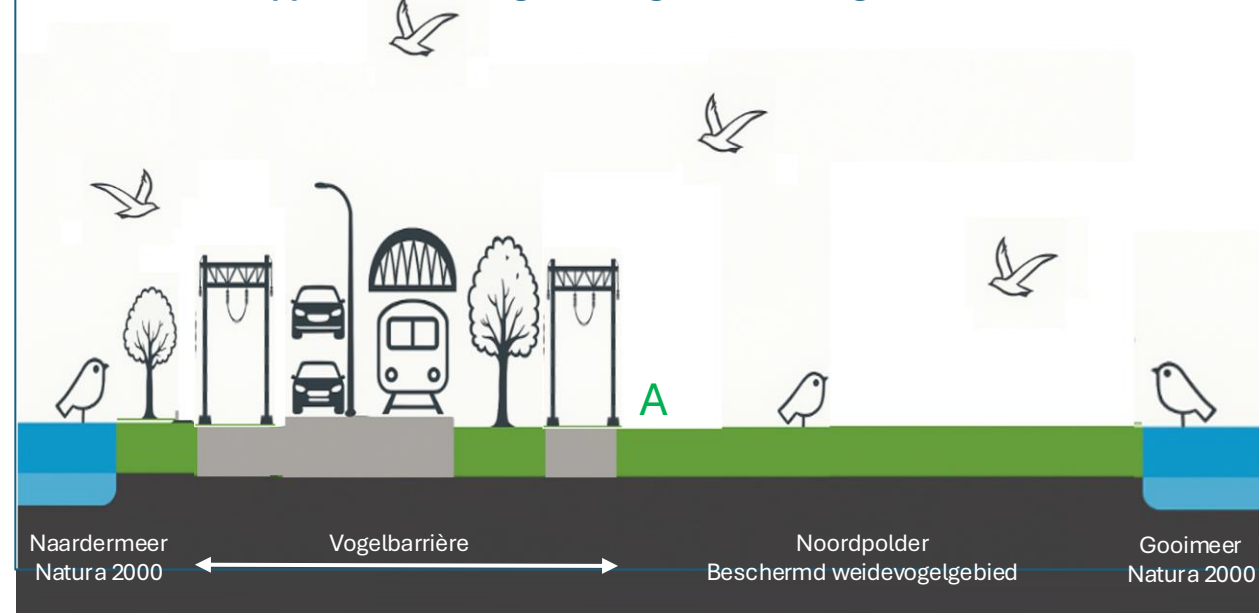
Knooppunt Muiderberg – Bovengrondse aanleg Voorkeurstracé
